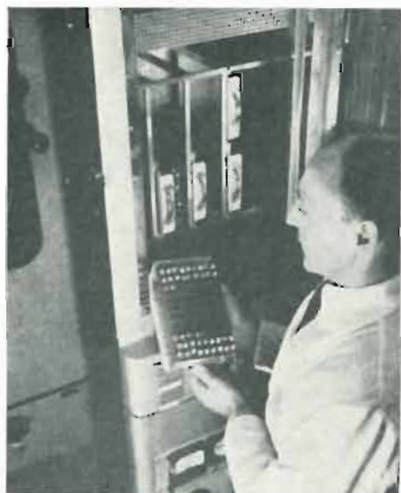
Fig' 1 - Veduta dell'interno di una stufa per la prova di funzionamento di lunga durata dei semiconduttori; in ogni stufa si trovano 6 telai che possono sostenere 100 pezzi ciascuno.
